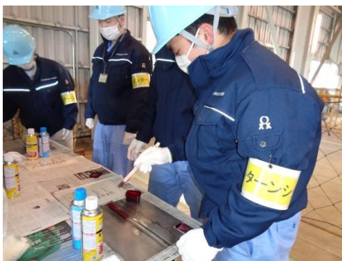
〈浸透探傷試験体験〉
